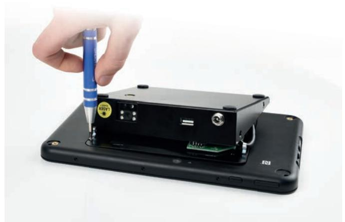
Befestigen Sie mit den M2x4 Schrauben den Modulrahmen am Tablet.
