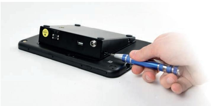
Schrauben Sie abschließend mit den M4x6 Schrauben die Abdeckung seitlich fest.
